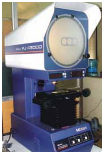
Máy phóng hình đo lường Mitutoyo (Nhật Bản) Profile projector Mitutoyo (Japan)
