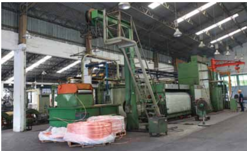
Máy kéo ù đồng liên tục Henrich (Đức) Henrich rod breakdown drawing machine with annealing of Germany
